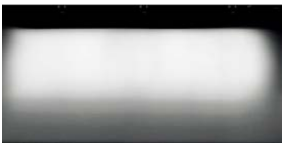
图 15 灯间距: 灯距离墙面距离: 墙面高 =1:1:3 照明效果演示
